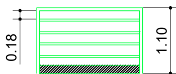
DETALHE GUARDA CORPO
